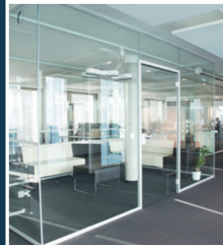
Schallschutz - Glas Trennwand 39 dB - L als Meetingpoint integriert, 1-schalig, rahmenlos geklebt, mit Glastür
