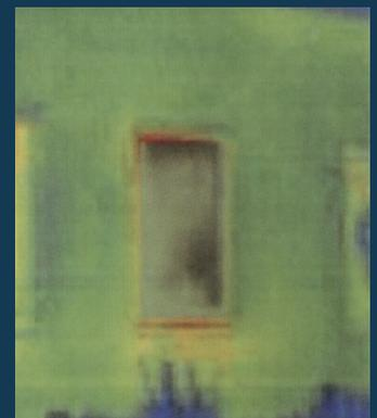
Wärmeschutzglas 1,0 W/m<sup>2</sup>K
